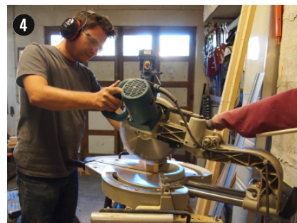
Découpage de tous les éléments à la scie radiale. On utilise une butée pour faire des séries de pièces identiques.
