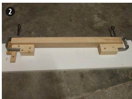
Gabarit de rabotage du gainage des pieds
