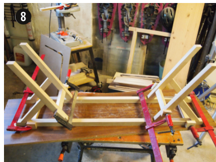
Assemblage final de la structure
