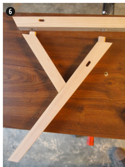
Usinage des faux tenons
