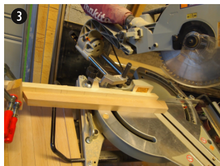
Découpage de tous les éléments à la scie radiale. On utilise une butée pour faire des séries de pièces identiques.
