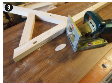
Usinage des trous pour palettes d'assemblage
