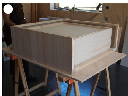
Assemblage du côté A2 sur le cadre C par collage et vissage
