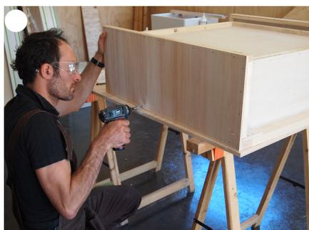
Assemblage du côté A1 sur le cadre C par collage et vissage
