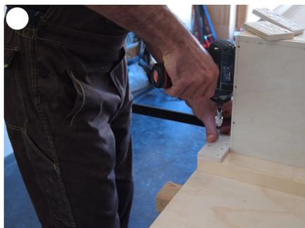
Assemblage du cadre C sur le caisson B par collage et vissage
