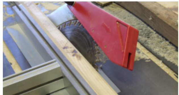
Figure 4: Usinage à 45° du manche sur scie circulaire sur table
