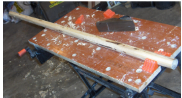
Figure 5: Usinage de la forme cylindrique au rabot à main
