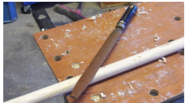
Figure 6: Finitions à la râpe et au papier de verre
