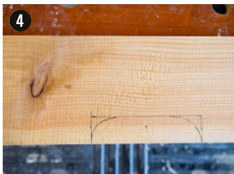
Usinage du trou oblong constituant la poignée
