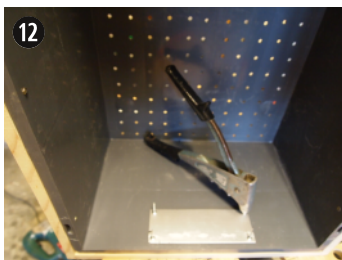
Plaque rivetée pour boucher la poignée.
