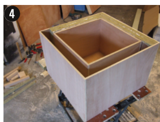
4 Isolation et assemblage des caisses
