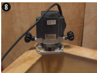
Finition de l'ouverture à la défonceuse munie d'une fraise à agrafer
