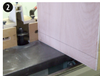
2 Découpe du couvercle avec une scie montée sur la toupie
