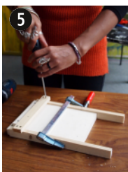
Montage d'usinage pour châssis éolienne.
