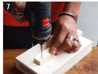
7 Perçage des traverses sur une cale martyre
