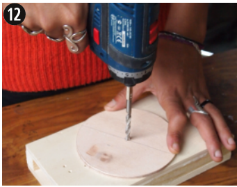
Percage de l'axe de la turbine
