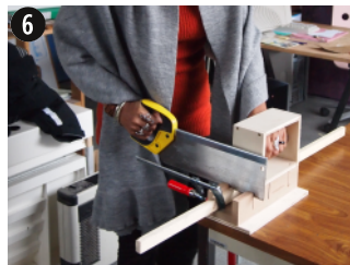
6 Sciage des montants et traverses avec la boîte à coupe sécurisée
