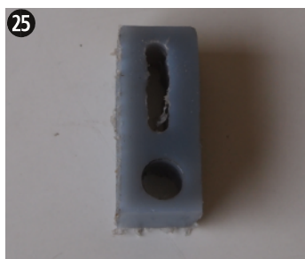
Pièce de guidage en rotation de l'axe (remplace le crochet)
