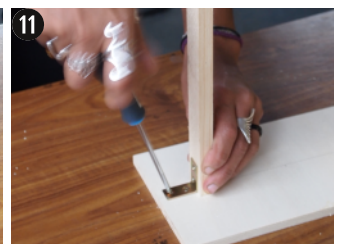
11 Fixation des équerres sur la base
