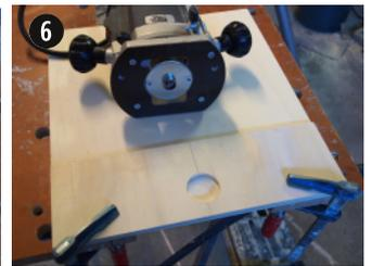
❻ Usinage : évidement des poignées, défonceuse, douille à copier et gabarit.
