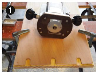
❶ Usinage des rainures, défonceuse, douille à copier et gabarit.
