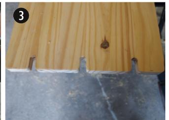
❸ Usinage des rainures, défonceuse, douille à copier et gabarit.
