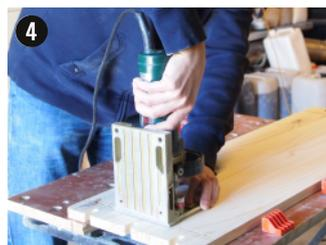
❹ Usinage des encoches des lamelles d'assemblage.
