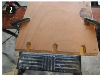
❷ Usinage des rainures, défonceuse, douille à copier et gabarit.
