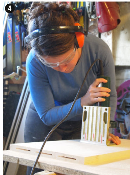
Usinage des encoches pour les palettes d'assemblage avec une lamelleuse
