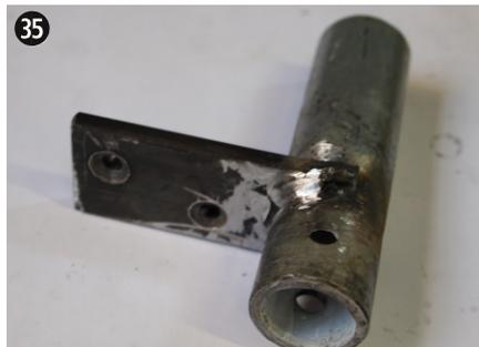
Soudage d'une patte sur le tube de l'attache du cadre et du timon
