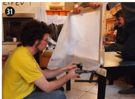
On agrafe ensuite un troisième côté sur le bord d'une planche qu'on a fixé avec deux serre-joints à une table
