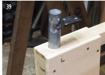
On insère au marteau l'attache F3 dans le châssis
