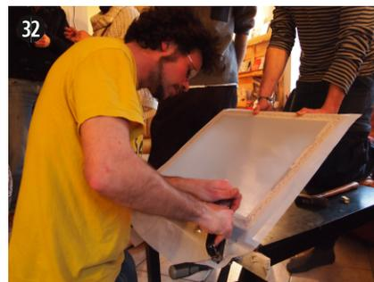
On incline alors le cadre en arrière pour mettre en tension la toile et une fois la tension voulue obtenue (crépitement du tissu), on agrafe la toile sur le cadre
