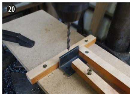
20 Montage d'usinage pour percer en série les pièces D8
