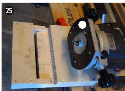
25 Usinage des mi-bois à l'aide d'une défonceuse, d'une douille à copier et d'un gabarit
