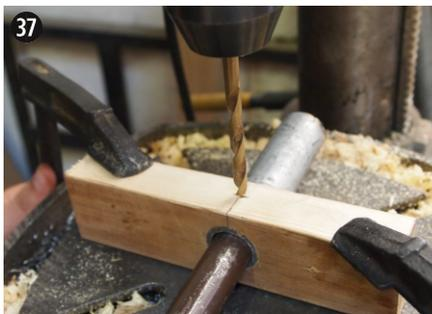
Perçage du trou de goupille dans les pièces F1 et F3 à l'aide d'un montage d'usinage
