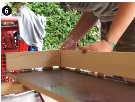
Assemblage des étagères par collage et vissage
