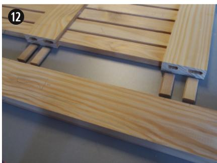
12 Usinage des faux tenons du plateau
