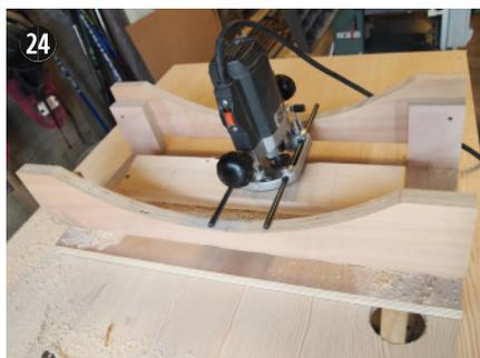
Gabarit d'usinage de la forme cylindrique des dossiers
