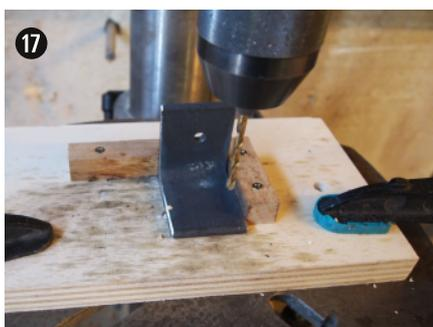
17 Usinage des équerres. Le montage d'usinage en bois permet une production en série précise.
