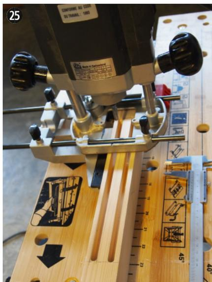
Usinage des rainures à l'aide du guide parallèle de la défonceuse
