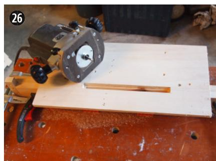
Usinage des rainures à l'aide d'une douille à copier guidée dans un gabarit
