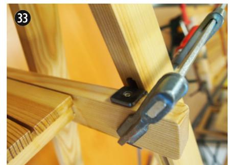
Fixation de la pièce métallique E. On la maintient en position avec un serre-joint et on visse.
