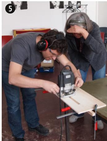
Réalisation des rainures avec gabarit, défonceuse et douille à copier
