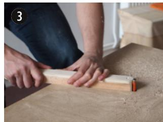
Usinage des arrondis avec défonceuse montée sous table et fraise à araser.
